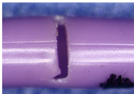
Figur 1: Exempel på tvärgående/perifer spricka i kateterslangen
